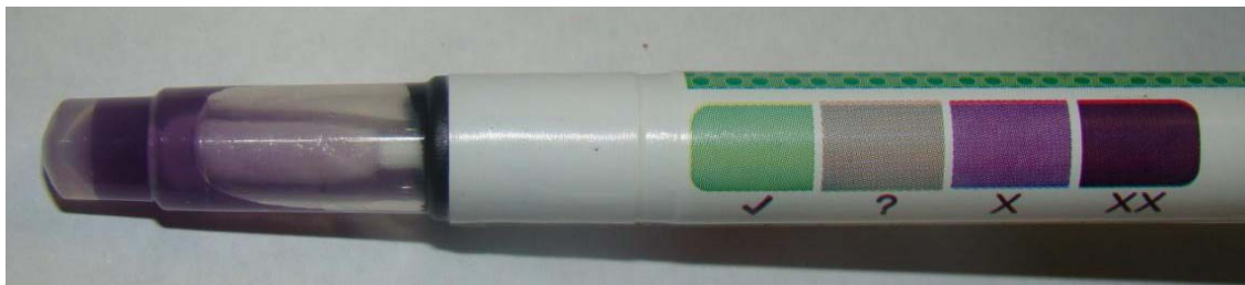
Figura 4 – Clean-Trace™ Surface Protein Plus mostrando resultado que indica resíduos de proteína na superfície amostrada.
